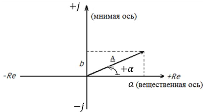
Рис. 1.7. Изображение вектора  $\underline{A}$  в комплексном виде
